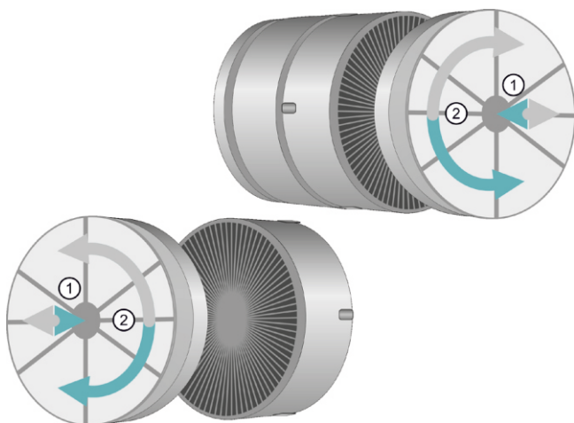
Рис. 14 Установка угольного фильтра
