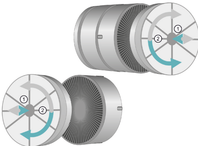
Рис. 14 Установка угольного фильтра
